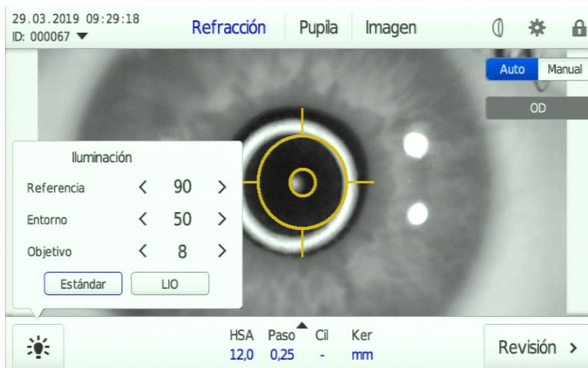
Fig. 28 Ventana emergente con los parámetros de iluminación desplegados
